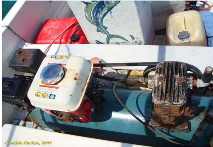
Ilustración 4. Compresor de aire utilizado en la captura de langosta. Foto: Oswaldo Huchim 2009.
